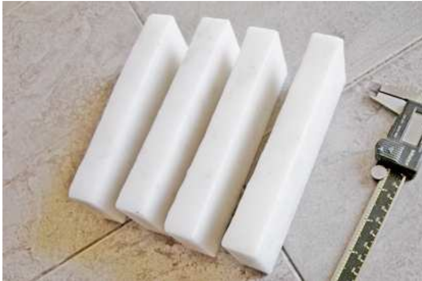
Probetas de propergol NK/SO Están aún sin imprimación ni bordes inhibidos.
