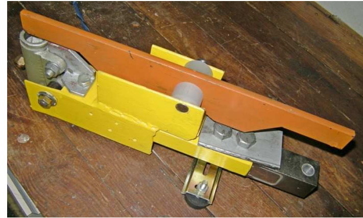
Sistema mecánico para calibración celda de carga.
