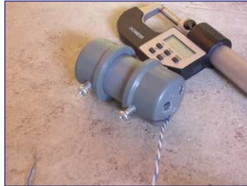
Micromotor iniciador, cuerpo de PVC.
