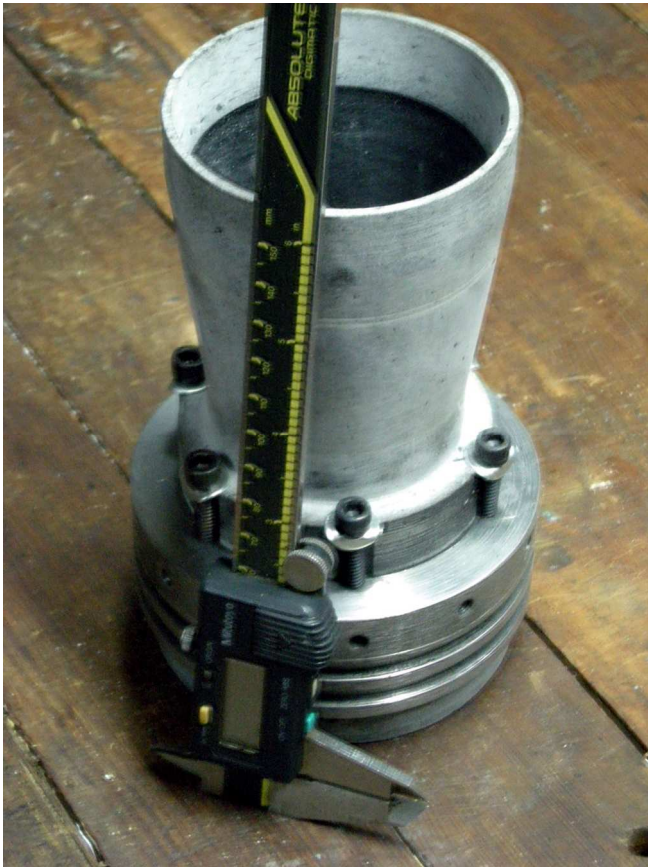
Tobera motor cohete Vettor 3. Sección divergente de material ablativo.
