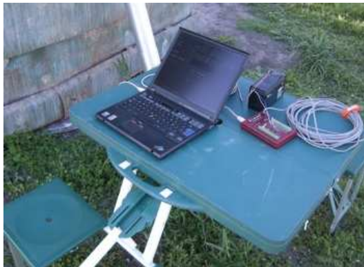
Conversor A/D y Notebook para registro datos 2° ensayo Vettor.
