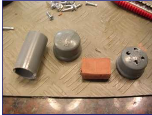
Componentes del micro motor iniciador, cuerpo de PVC.
