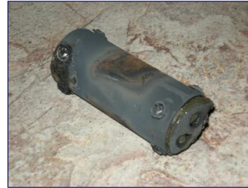
Micromotor iniciador ensayado, cuerpo de hierro.
