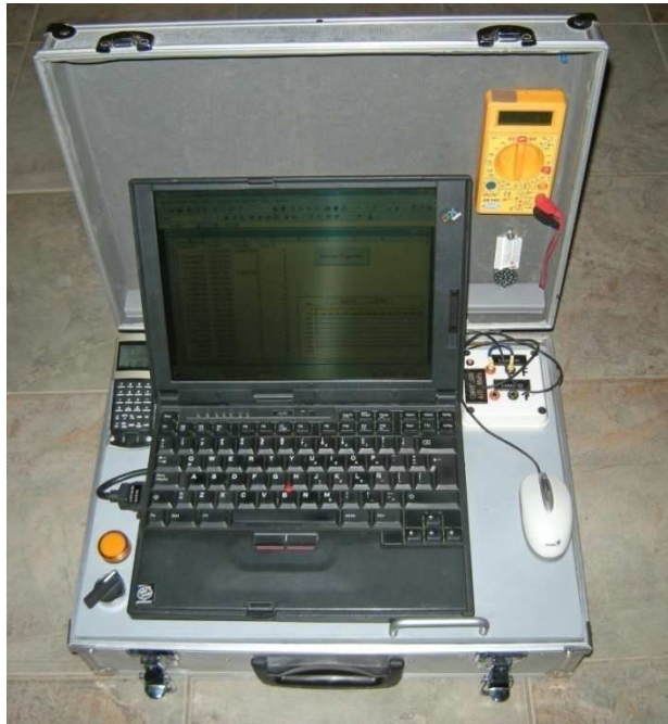
Maleta con todo el sistema electrónico para toma y registro de valores del ensayo del motor cohete.
