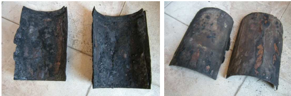
Manguitos inhibidores rotos, recuperados del ensayo motor cohete Vettor, prueba primera.
