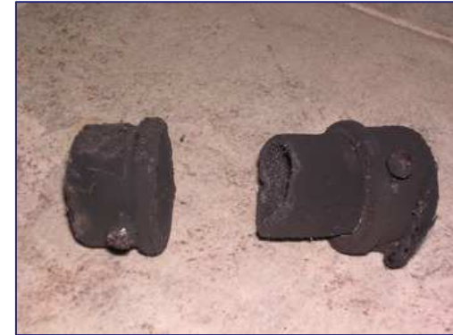
Micromotor iniciador ensayado, cuerpo de PVC.
