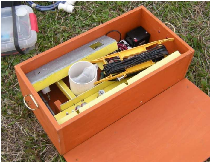
Componentes del sistema para calibración celda de carga y transductor de presión.
