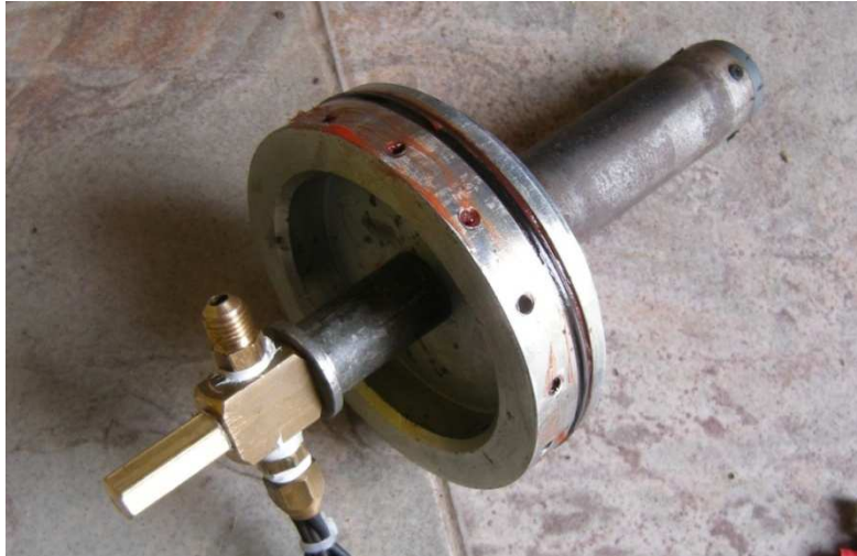
Tapa del motor cohete Vettor con micro motor iniciador y toma de presión de cámara.
