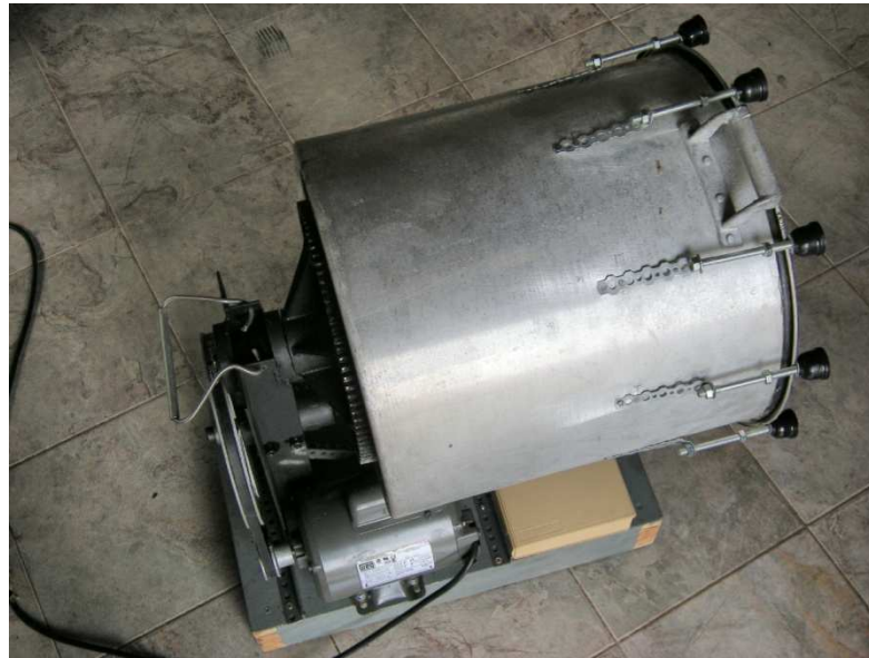
Mezcladora de sólidos de 50 dm 3 .
